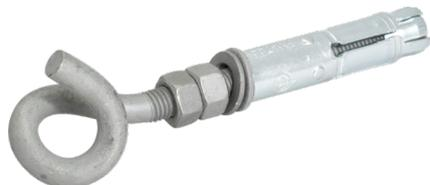
Le boulon queue de cochon avec cheville métallique Telenco® BQC12x110E est utilisé pour la fixation d'un câble de distribution sur une façade en matériau dur, comme le béton ou la pierre. Il est composé d'un boulon queue de cochon en acier galvanisé M12 x 110 mm, équipé de deux écrous et de deux rondelles.
