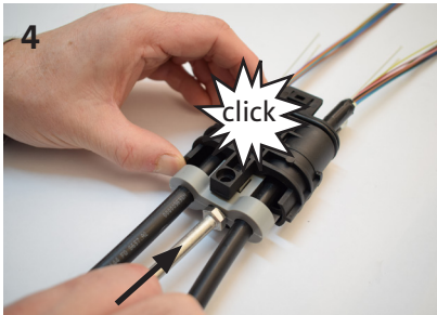
4 Pousser et enfoncer l'entretoise supérieure à l'intérieur du corps
