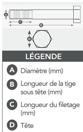
Les boulons traversants Telenco® permettent la fixation d'équipement poteau sur les appuis perçables ou pré-perçés. En fonction de leur longueur, ils peuvent également être utilisés pour la réalisation de moisage. Dans ce cas, l'utilisation de deux plaquettes est nécessaire.
