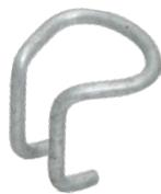
Ce crochet s'installe directement sur le poteau à l'aide d'un feuillard fixé par une boucle, d'un boulon traversant ou d'un tirefond équipés d'une plaquette courbe.
