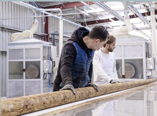
Les poteaux télécoms composites Telenco® sont fabriqués en France par un procédé de centrifugation garantissant une répartition homogène des fibres et de la résine. Cette technologie confère aux poteaux une résistance accrue aux conditions climatiques les plus extrêmes et assure leur longévité sur plusieurs décennies.
