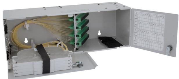
Der APL XXL wird für den Anschluss des Verteilerkabels an die Steigleitung verwendet und ist für die direkte Wandmontage am Gebäudeeingang konzipiert. Dank zahlreicher Kabeleinführungen und Spleißkassetten ermöglichen stapelbare APL XXL die Verbindung zwischen dem ISP (Internet Service Provider) und Kundenanschlusskabeln.
