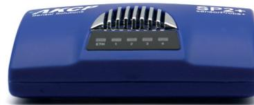
Hub de données, équipé de 4 prises RJ-45 et d'une prise Ethernet, avec un module GSM en option. Prend en charge 4 capteurs intelligents ou jusqu'à 20 entrées. Il est possible de connect des modules d'extension.
