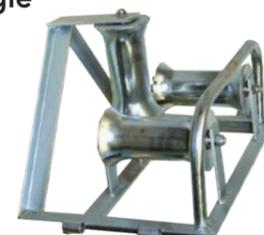
Galet structure acier constitué de 3 rouleaux en acier avec roulements à billes. Ils s'utilisent par paire pour les passages d'angle de bâtiment mais peuvent également être reliés à plusieurs pour les parcours en tranchée plus complexes grâce à leurs pattes de fixation.
