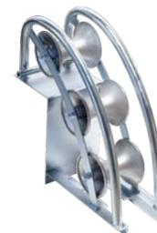
Galet structure acier avec 3 rouleaux en alliage d'aluminium très résistant à l'usure avec roulements à billes, ne nécessite pas d'entretien, les axes sont protégés contre la poussière et l'encrassement.
