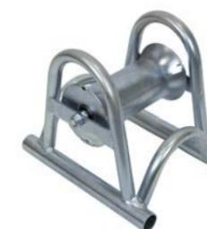
Galet de déroulage structure en acier galvanisé avec rouleau en alliage d'aluminium très résistant à l'usure. Ne nécessite pas d'entretien, les axes sont protégés contre la poussière et l'encrassement.
