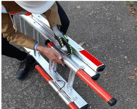
Déploiement des compensateurs à l'aide des goupilles
