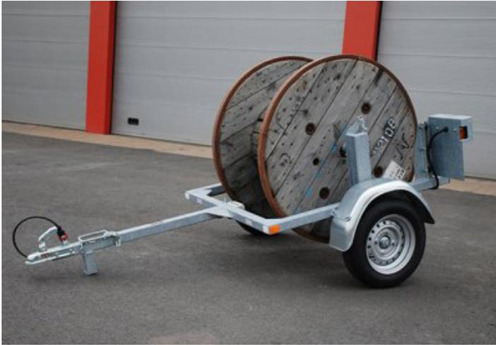
Remorque dérouleuse routière sans frein pour le transport et le déroulage des tourets jusqu'à 395kg. De conception simple et robuste son châssis est en acier galvanisé à chaud. Le chargement, déchargement des tourets se fait par basculement.
