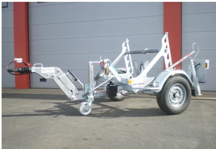
Remorque dérouleuse routière avec frein pour le transport et le déroulage des tourets de câble jusqu'à 1020 kg. De conception simple et robuste son châssis est en acier galvanisé à chaud. Le chargement, déchargement des tourets est assisté par un balancier hydraulique (à pompe manuelle).
