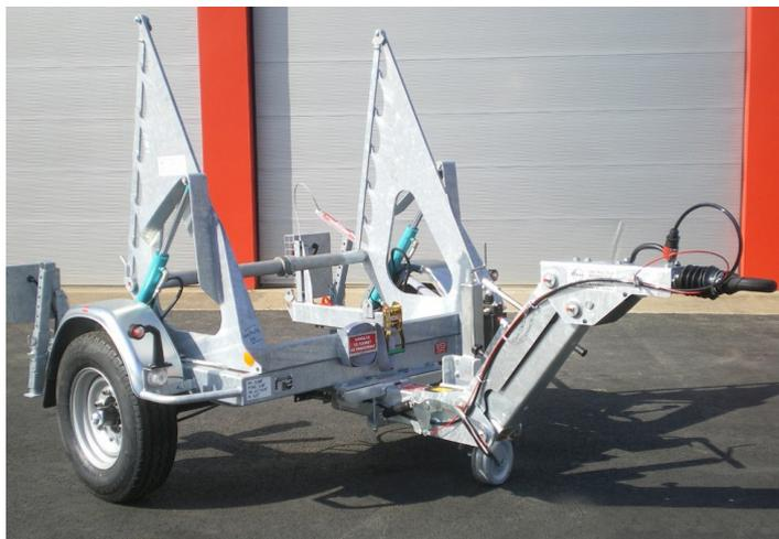
Remorque dérouleuse routière avec frein pour le transport et le déroulage des tourets de câble jusqu'à 1820 kg. De conception simple et robuste son châssis est en acier galvanisé à chaud. Le chargement, déchargement des tourets est assisté par un balancier hydraulique (à pompe manuelle).
