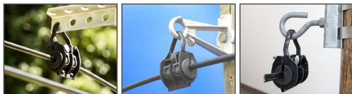
Les dispositifs diélectriques Telenco® DS5/DS8/DS12 / DS15 permettent la suspension mobile des câbles ADSS de Ø 5 à 17 mm au niveau des poteaux intermédiaires sur réseau de distribution (portées jusqu'à 70 m).
