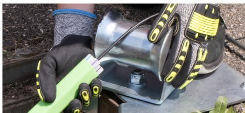
Galet bord de chambre pour déployer du câble, une ficelle d'aiguillage, ou une corde de tirage dans une conduite.
