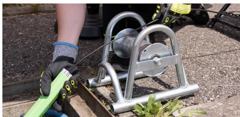
Galet droit de déroulage pour déployer du câble, une ficelle d'aiguillage, ou une corde de tirage dans une conduite.
