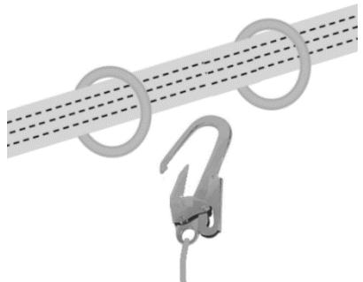
Por isso, a qualquer momento, apenas uma pessoa e/ou utilizador deve ser ancorada/ligada a cada um dos anéis em O.
