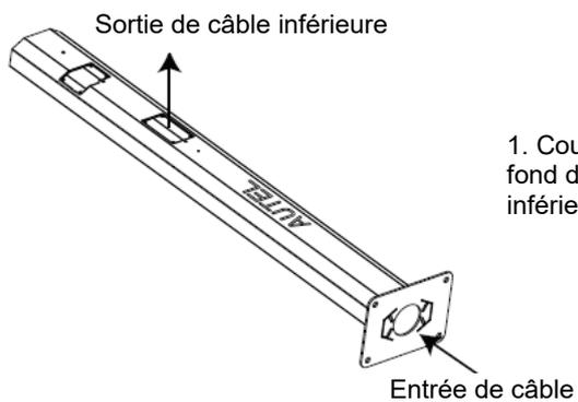
1. Couchez le piédestal. Faites le câble passer par le fond du piédestal et sortir de la sortie de câble inférieure.
