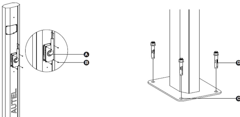
2. Faites passer le câble par la plaque de fermeture de la sortie de câble inférieure (A). Fixez la plaque au piédestal en vissant quatre vis M3 x 6 (B) dans les trous. Serrez les vis.
