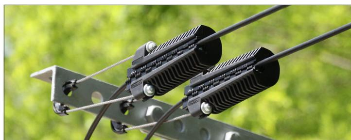
Les pinces d'ancrage Telenco® AC56R et AC68R permettent de réaliser l'arrêt de câbles aériens FTTH de structure ronde d'un diamètre de 5 à 8 mm. Elles sont utilisées sur poteau ou façade, sur des portées jusqu'à 70 m. Ses coins sont conçus avec un design enveloppant spécifique permettant à ces pinces un accrochage optimisé du câble. En cas de surcharge, la pression est répartie uniformément afin de préserver les performances optiques du câble.
