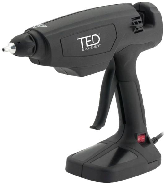
Le pistolet à colle professionnel TED® filaire est un outil professionnel très apprécié pour son efficacité, sa précision et sa simplicité d'exécution. La température de fusion (195°C) est atteinte en seulement 2 minutes. La buse de précision permet un collage précis, le socle permet de le maintenir droit afin d'éviter les coulures. Facile à manier, sa petite taille et son ergonomie permettent une utilisation adaptée aux métiers des télécoms.
