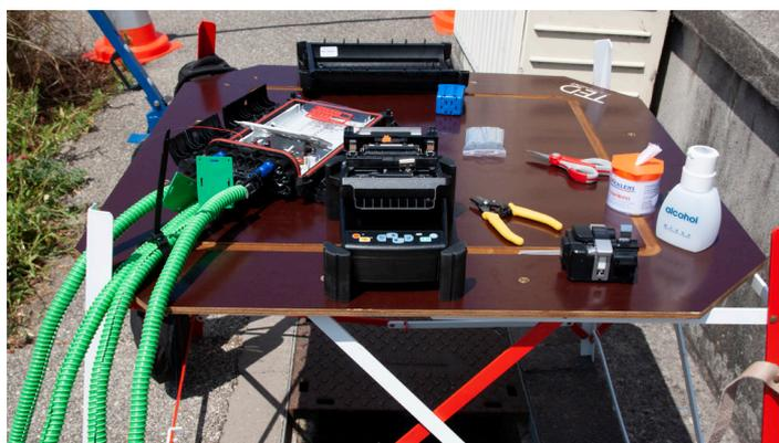
Les trous pré-perçés existent à droite et à gauche de la table TED afin de s'adapter aux besoins de tous les techniciens (droitiers ou gauchers) et à toutes les configurations de raccordements.
