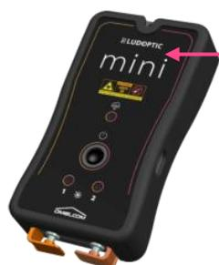
**Ludoptic mini 2 lasers de puissance réglable de 1 à 30 mW**
