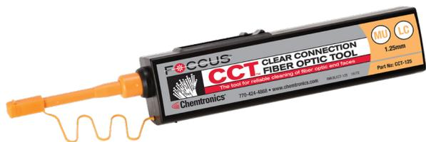
Le stylo CCT permet un nettoyage à sec des connecteurs installés sur les cordons optiques ou les faces avant des tiroirs de brassage. Facile et rapide d'utilisation : un seul clic suffit pour nettoyer efficacement une fêrulle. En appliquant une légère pression sur le bouton prévu à cet effet, le mécanisme du stylo fait avancer le tissu sur une pointe de nettoyage.
