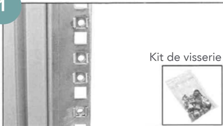
Appliquer sur le rack 8x écrous-cages, 4x de chaque côté (M6 - 11x11x4,5 mm) 2 par U
