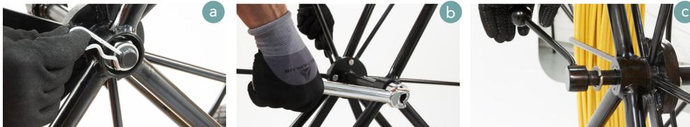
**4 Réserver tous les éléments du frein**
