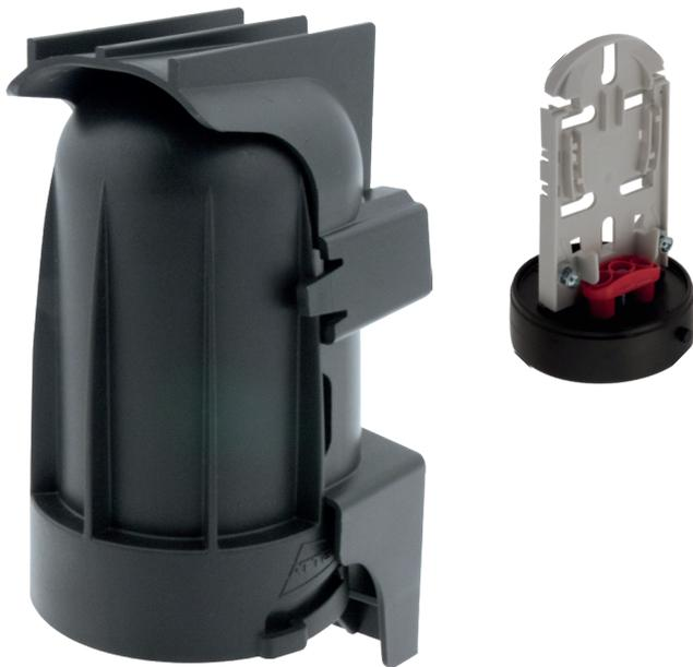
Le boîtier de protection d'épissure mini-dôme permet d'effectuer une transition entre deux câbles de branchement d'abonné. Il peut être installé en intérieur ou extérieur sur poteau, en façade, en chambre ou directement en pleine terre. Il est appliqué en limite de propriété comme un point de démarcation délimitant ainsi le domaine privé du domaine public.
