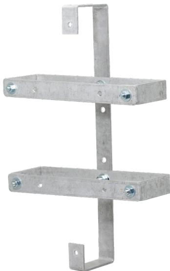
La croix de lovage Telenco® 350 offre un large espace pour la gestion des sur-longueurs de câbles. Livrée en kit, la croix de lovage 350 est composée de pièces en aluminium et de vis en acier inoxydable compatibles pour sa fixation. Dimensions : 568 x 358 mm.
