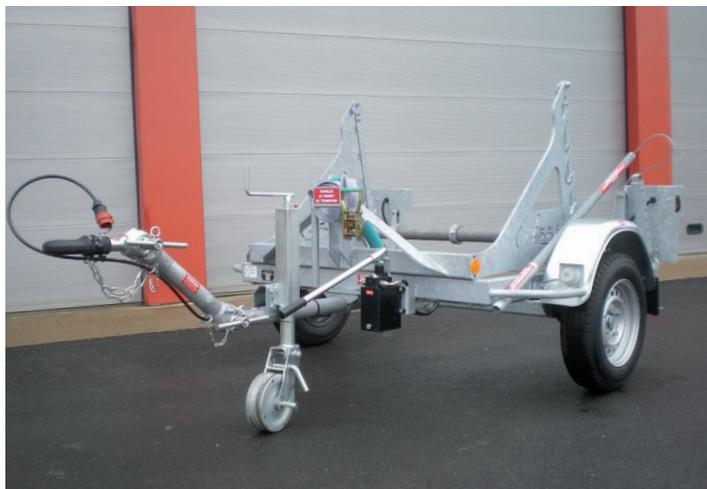
Remorque dérouleuse routière sans frein pour le transport et le déroulage des tourets jusqu'à 430 kg. De conception simple et robuste son châssis est en acier galvanisé à chaud. Le chargement, déchargement des tourets est assisté par un balancier hydraulique (à pompe manuelle).
