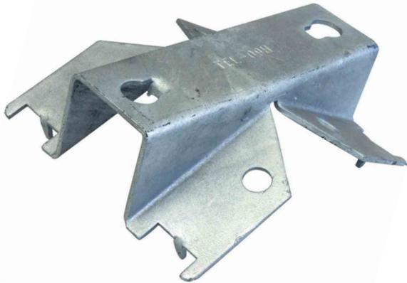
Le support de poteau Telenco® CPB est utilisé pour fixer les traverses 5/15 et 5/19 sur un poteau en bois commun. Le CPB est installé sur le poteau à l'aide de deux feuillards de 20 x 0,7 mm équipées de boucles. Deux boulons d'assemblage 1/12 (vendus séparément) sont nécessaires pour fixer la traverse sur la CPB.
